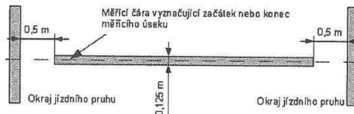
Obr. 2 Vyznačení začátku a konce měřicího úseku měřicí čarou
