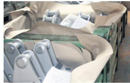
Takto vypadá finální produkce příbramské galvanovny - kovové komponenty opatřené povrchovou ochrannou vrstvou.
