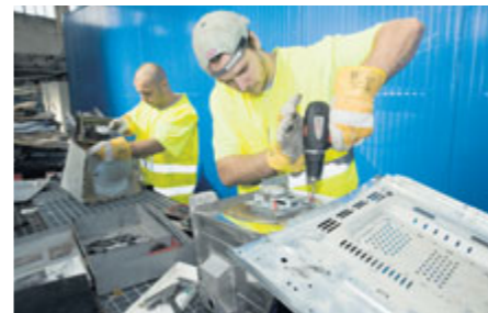
Po odsání freonu se demontuje vše, co lze recyklovat. Foto: Elektrowin
