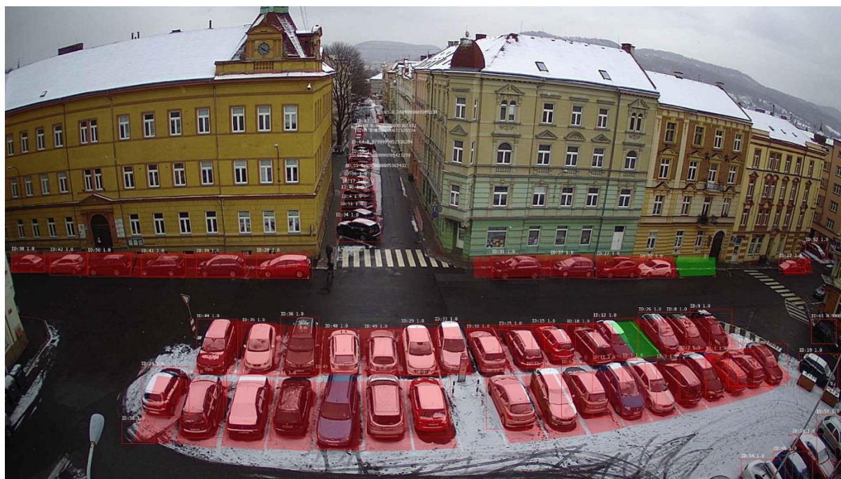
Obrázek 21 Vzor sledování obsazenosti parkoviště pomocí kamer (Zdroj: smartiple.com)
