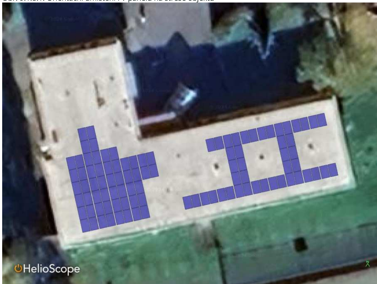
Obr. 9.1.8.1: Orientační umístění FV panelů na střechu objektu
