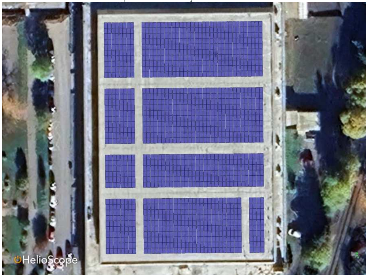
Obr. 9.1.3.1: Orientační umístění FV panelů na střechu objektu
