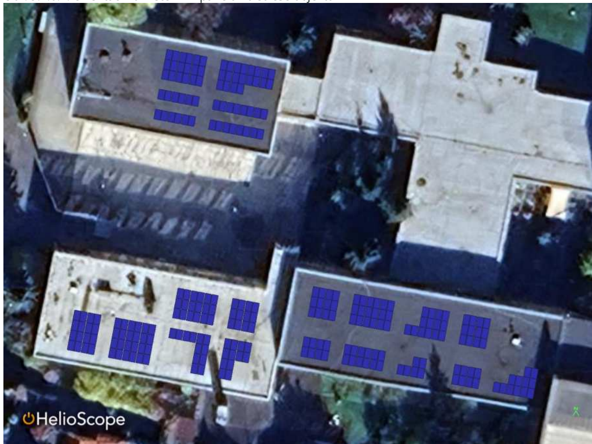
Obr. 9.1.6.1: Orientační umístění FV panelů na střechu objektu
