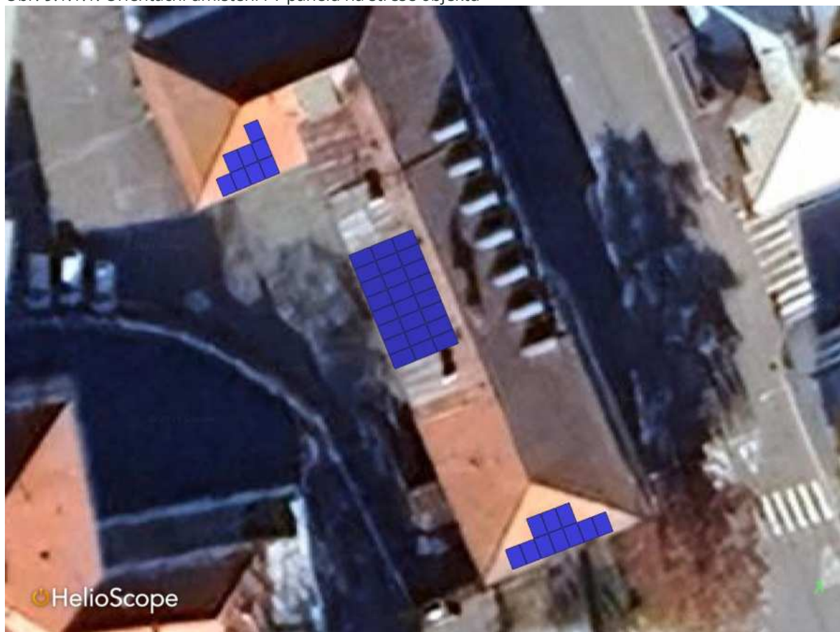
Obr. 9.1.1.1: Orientační umístění FV panelů na střeše objektu
