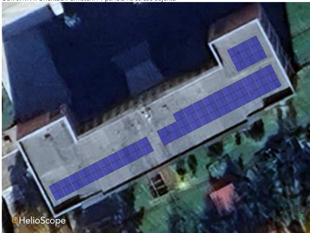
Obr. 9.1.7.1: Orientační umístění FV panelů na střechu objektu
