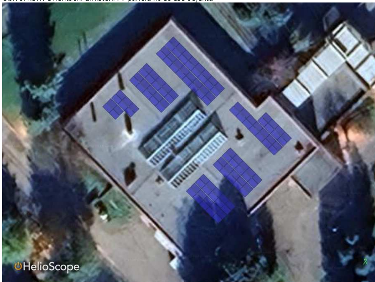
Obr. 9.1.5.1: Orientační umístění FV panelů na střechu objektu
