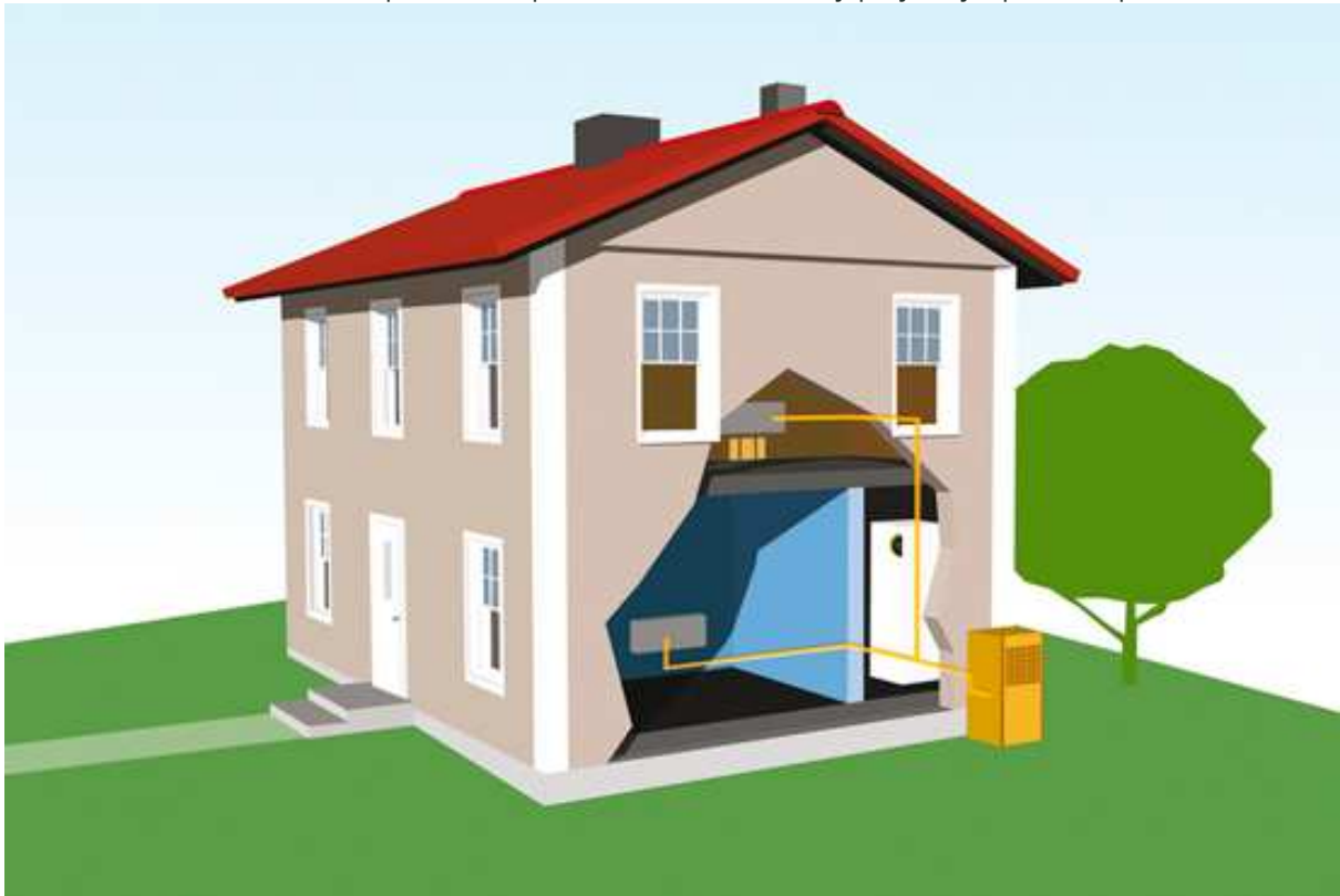
Obr. 9.5.5: Schéma instalace tepelného čerpadla vzduch-voda (Zdroj: projektuj-tepelna-cerpadla.cz)
