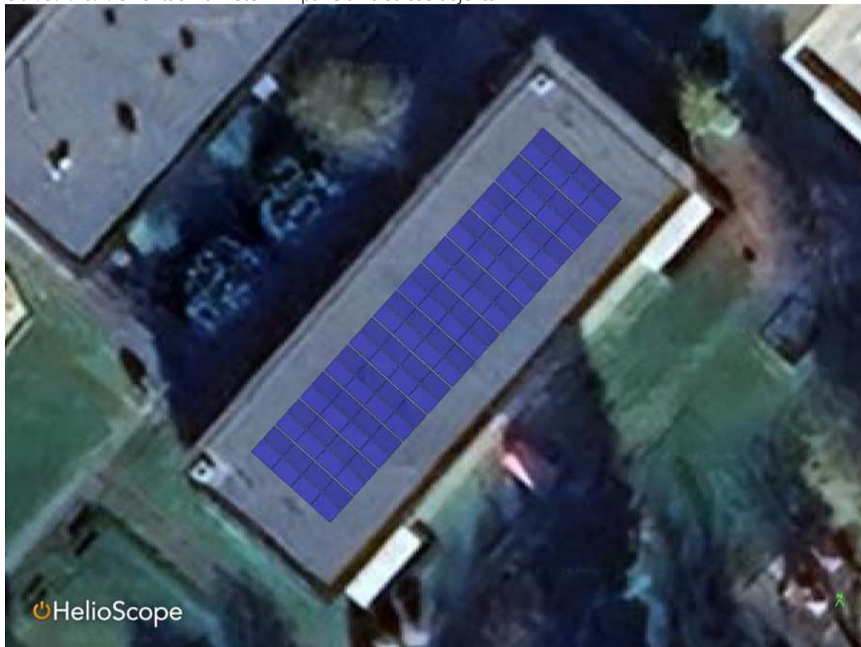
Obr. 9.1.10.1: Orientační umístění FV panelů na střechu objektu
