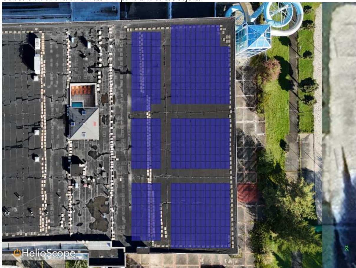
Obr. 9.1.2.1: Orientační umístění FV panelů na střechu objektu
