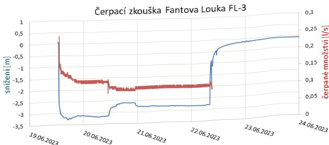
Obr. 20: Průběh hydrodynamické zkoušky na vrtu FL-3.
