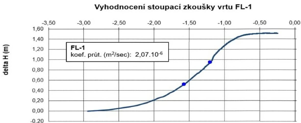
Obr. 16: Vyhodnocení stoupací zkoušky na vrtu FL-1.
